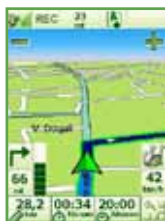
Fig. 3 - Tryck på fältet med namn på den aktuella vägen för att visa kvarvarande resttid, avstånd till nästa vägpunkt och beräknad ankomsttid.
